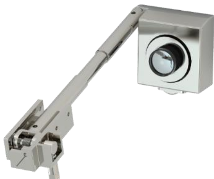
Rysunek 7. Przykładowe zdjęcie SHS w wersji dla satelitów, jaki oferuje Scanway
